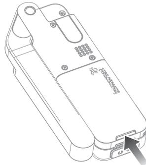
1 Retirer la batterie en appuyant sur le loquet et en la soulevant pour l'extraire du téléphone.
