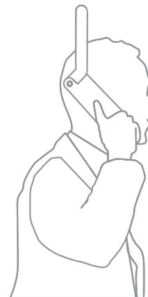
Placez-vous à l'extérieur, avec une vue dégagée du ciel, et orientez l'antenne du téléphone vers le haut. La distance entre l'antenne du téléphone et le satellite doit être dégagée.
