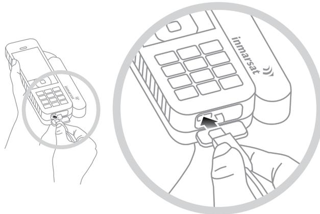
Branchez le chargeur sur une source d'alimentation et la prise micro-USB sur le connecteur situé à la base du téléphone, sous le cache de protection USB/audio.
